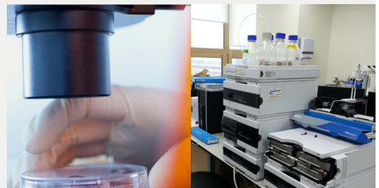
ApoA1 단백질과 항암물질인 에포틸론을 분석하기 위한 고성능액체크로마토그래피(HPLC) 장비
